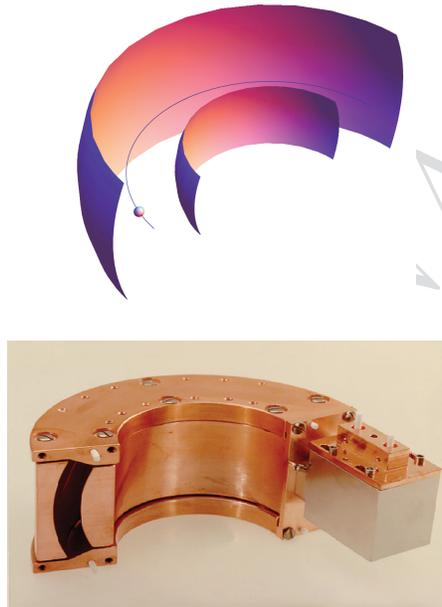
Figura 10.5: Analizador de electrones de sectores esféricos.
