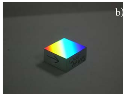
Figura 15: a) Origen de la interferencia constructiva producida por una rejilla de difracción. b) Rejilla real dispersando en varios colores luz natural.
