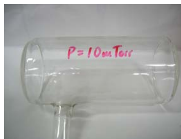
Figura 39: Celda con vapor de Rubidio construida con una presión interna de 10 mTorr.
