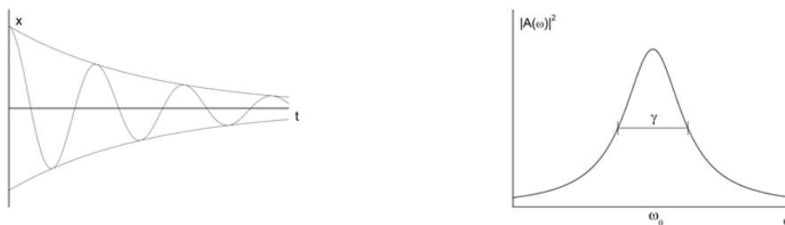
Figura 20: a) Oscilación amortiguada. b) Perfil de intensidad I(\omega - \omega_0) obtenido por medio de la Transformada de Fourier de x(t) .
